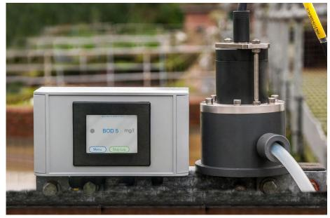
Sonda per il rilevamento in situ in tempo reale di parametri di fluorescenza UV, tra cui: idrocarburi policiclici aromatici (PAH).
