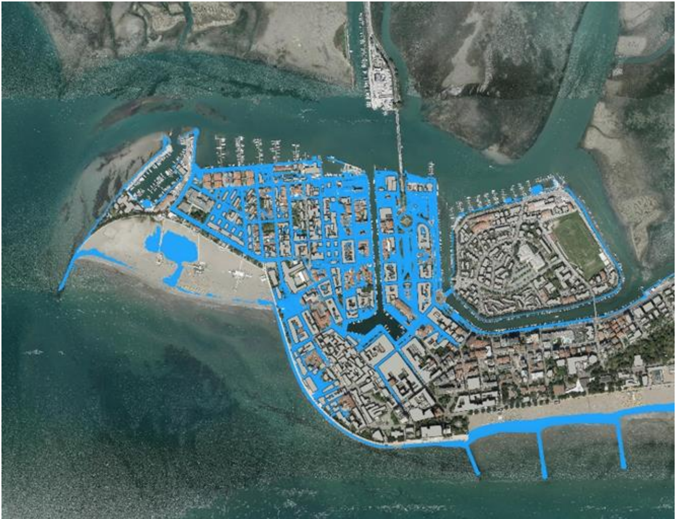
Mappa di allagabilità di Grado a oggi, nell'ipotesi di un aumento episodico del livello del mare pari a 128 cm. La mappa è stata elaborata dal Coastal Group dell'Università di Trieste sulla base del rilievo LIDAR della protezione Civile FVG del 2018. La base della figura è la foto aerea del 2018 (da Regione Autonoma Friuli Venezia Giulia - https://eaglefv.giulia.regione.fvg.it )
