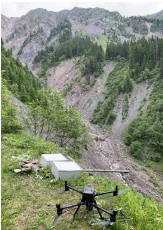
Stazione in quota per il rilievo delle colate e drone per la scansione laser.
