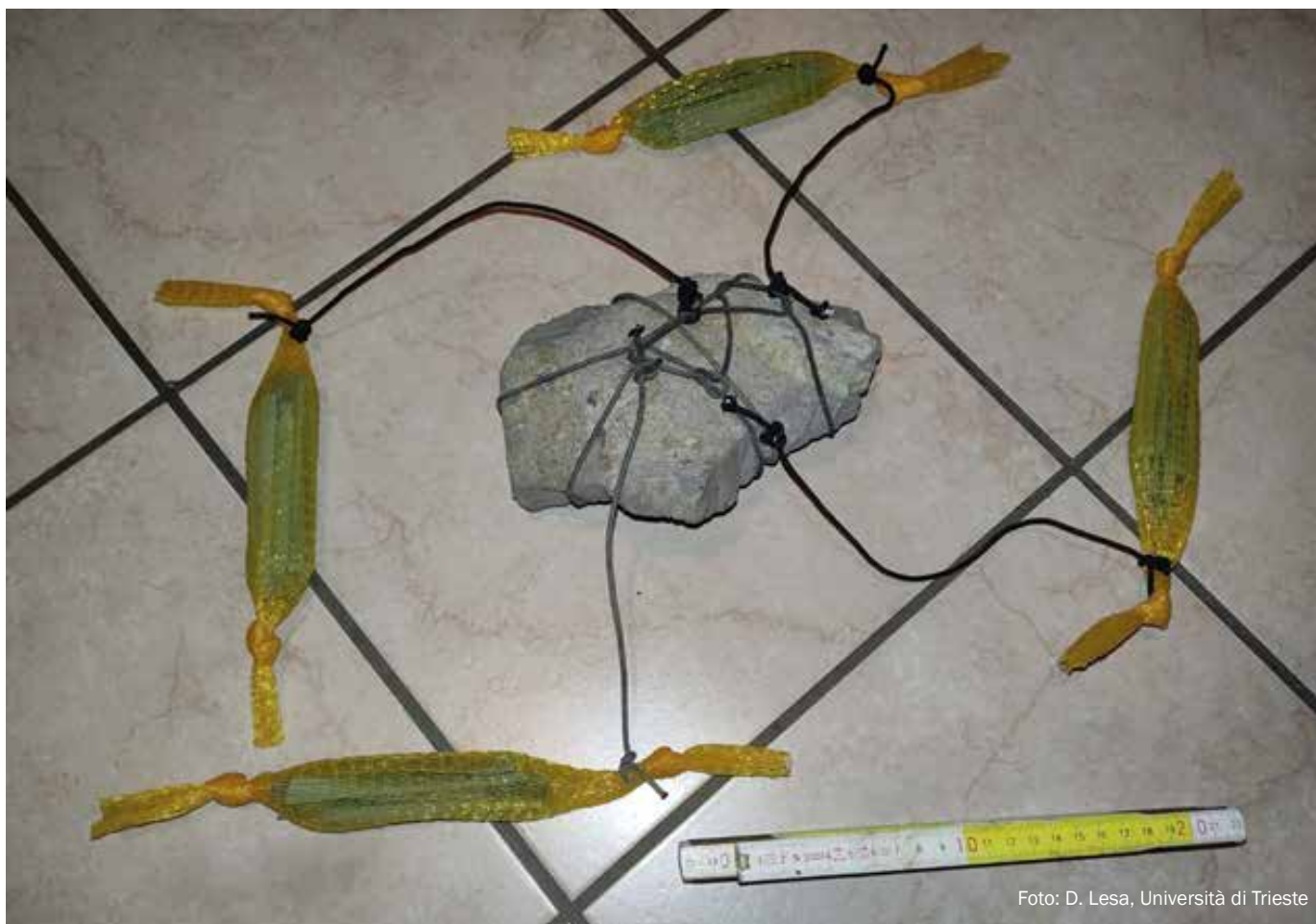
Unità sub-campionaria utilizzata per il campionamento mediante pacchi fogliari ( leaf bag technique ).
