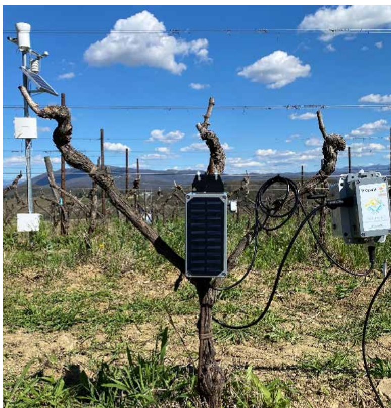
Sensoristica installata nel vigneto della azienda agricola Specogna (Corno di Rosazzo, UD). I sensori in foto misurano il flusso idrico della pianta e la disponibilità idrica a livello radicale.
